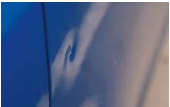
▲ Ремонт вмятин (как маленьких, так и довольно больших) зачастую можно выполнить без покраски детали
