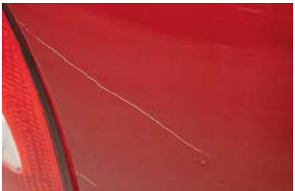
▲ Если дефект затронул слой базовой эмали, лучшее решение — локальный ремонт
